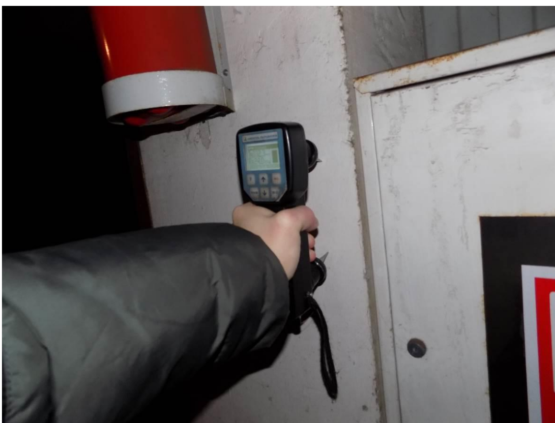
Испытание колонн первого этажа прибором УКС-МГ4.
