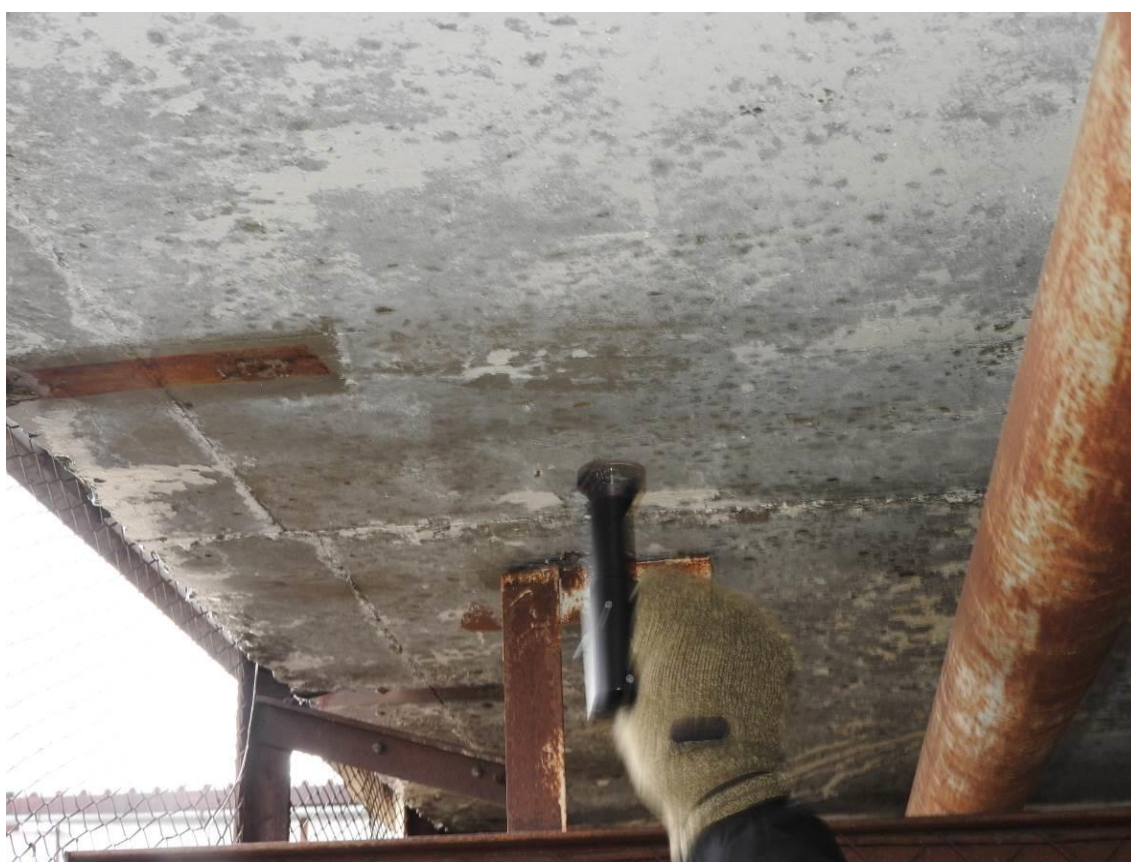
Замеры прочности плиты покрытия ударно-импульсным методом
